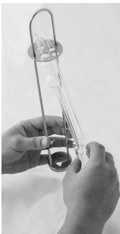
Abb. 5 Einführen bzw. Austauschen eines Viskosimeters mit Lichtschrankenabtastung
